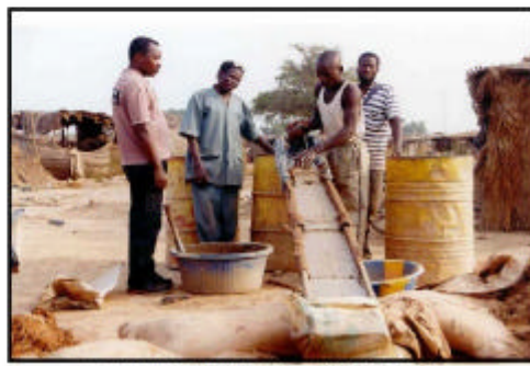
Levage du minerai au sulfate bore artisanal (20% de récupération)
