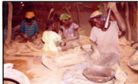
Pilage du minerai concassé
