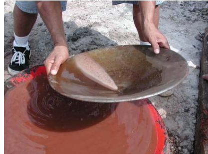
Fig. 4.21 - Using a steel batea (Brazil)
