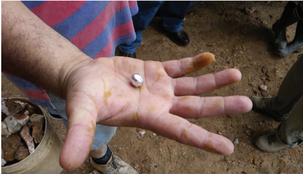
Figure 5. Amalgama de oro y mercurio normalmente tiene más de 50% mercurio, y se evapora para refinar.
