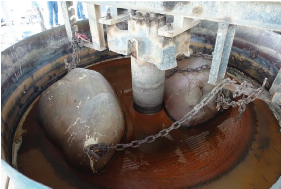
Figura 2. Rastras se componen de rocas planas de un lado que giran en círculos en una placa de metal. Las rastras son alimentadas con mineral, agua, y mercurio.
