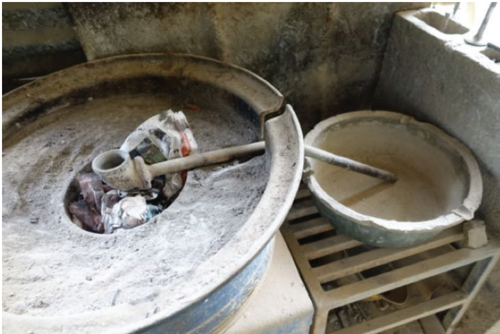
Figura 6. Retorta en una planta de rastras. Se tapa la tubería y quema. El vapor de mercurio se condensa en una tina llena de agua.
