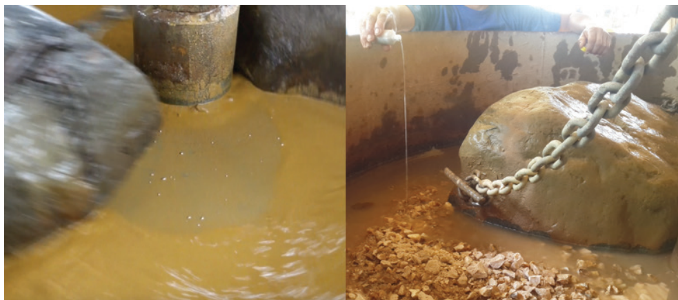
Figure 4. Adición de mercurio a la rastra (izquierda). Gotas de mercurio pulverizado (derecha)
