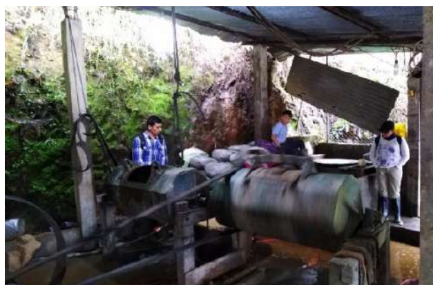
Foto 22. Chanchas en operación - Chinapintza
