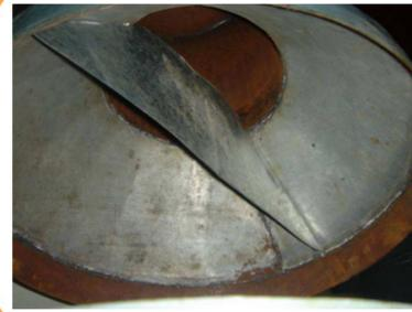
Parte interna del cono superior. Se muestra detalle del sistema para controlar el flujo del aire.
