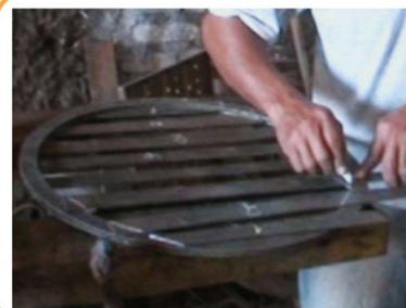
Un sistema colector de placas actúa como sistema de impacto para condensar las partículas de mercurio emitidas durante el proceso de purificación de las amalgamas de oro.
