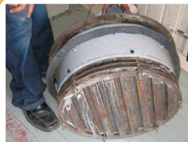
El ventilador y el sistema colector de placas son unidos con soldadura a un tambor de 200 litros.
