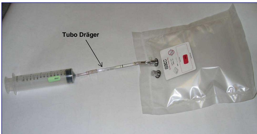
**FIGURA 5-4 Análisis de las muestras diluidas con tubo Dräger (foto)**
