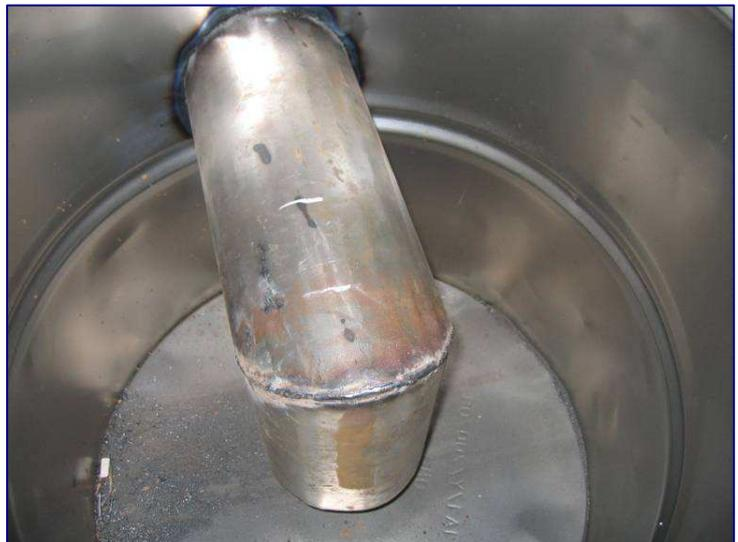
**FIGURA 3-4 Construcción del tambor de hierro y entrada de gas, entrada lateral (foto)**
