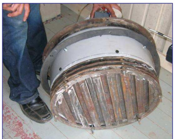
**FIGURA 3-10 Método propuesto para la construcción del sistema de placa desviadoras**
